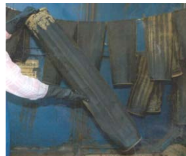
Durch Teer verklebte, unbrauchbar gewordene Filterschläuche
